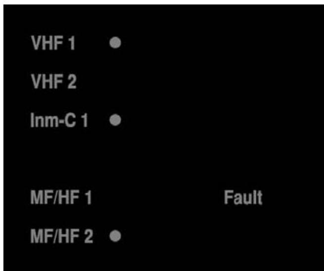
Для выяснения причины неполадки необходимо проверить подключенное оборудование. В примере выше необходимо проверить радиостанцию ПВ/КВ (MF/HF 1).
