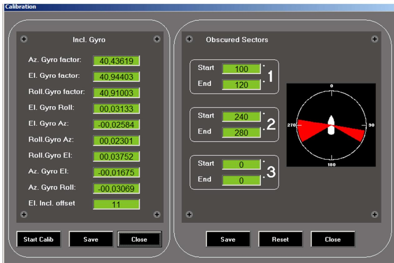
Панель калибровки включает в себя заводские установки блока инерциальных измерений (гироскоп). Перекалибровка должна быть выполнена только, если блок инерциальных измерений (IMU) был заменен.
