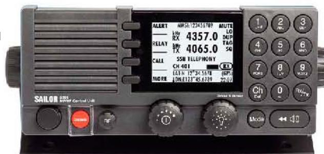
Большой дисплей отображает частоты приема/передачи, состояние радиостанции, номер MMSI, информацию о местоположении, свойства системы и канала, включая индикаторы мощности передатчика и уровня принимаемого сигнала. Данные легко просматривать почти при всех углах обзора, а яркость экрана может регулироваться для темного и светлого времени суток.
