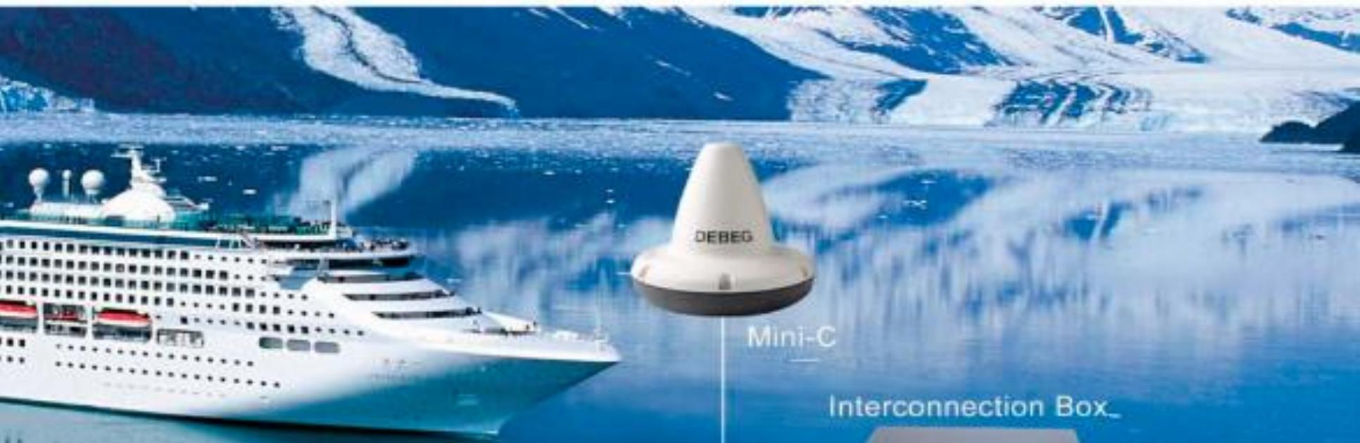
SSAS используется для подачи тревожных сообщений о нападении пиратов или вооруженном нападении при помощи потаенных кнопок, установленных в различных местах на судне (одна на мостике). Не является сигналом бедствия. Доставляется на единый пункт доставки страны флага судна. Не подтверждается. Периодически проводится проверка при помощи специальной кнопки "test". (Non GMDSS).
