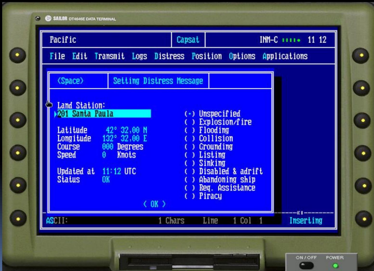
**ПЕРЕДАЧА**, предварительно заготовленного оператором по установленной форме, **DISTRESS MESSAGE**.
