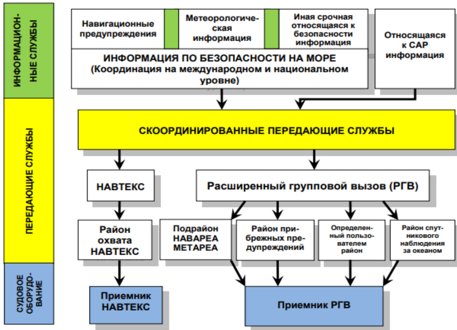
Рис. 1. Служба информации по безопасности на море Глобальной морской системы связи при бедствии и для обеспечения безопасности
